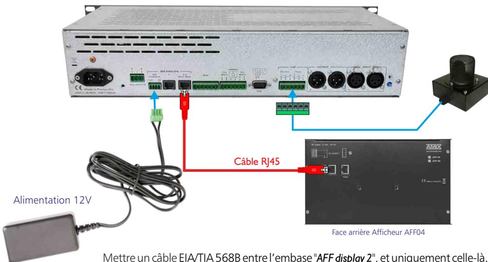
Mettre un câble EIA/TIA 568B entre l'embase "AFF display 2", et uniquement celle-là, du SNA et l'embase RJ45 (GPO1/GPO2) de l'afficheur pédagogique AFF04 (ou AFF08). Ce câble véhicule à la fois l'alimentation et la modulation de mesure.
